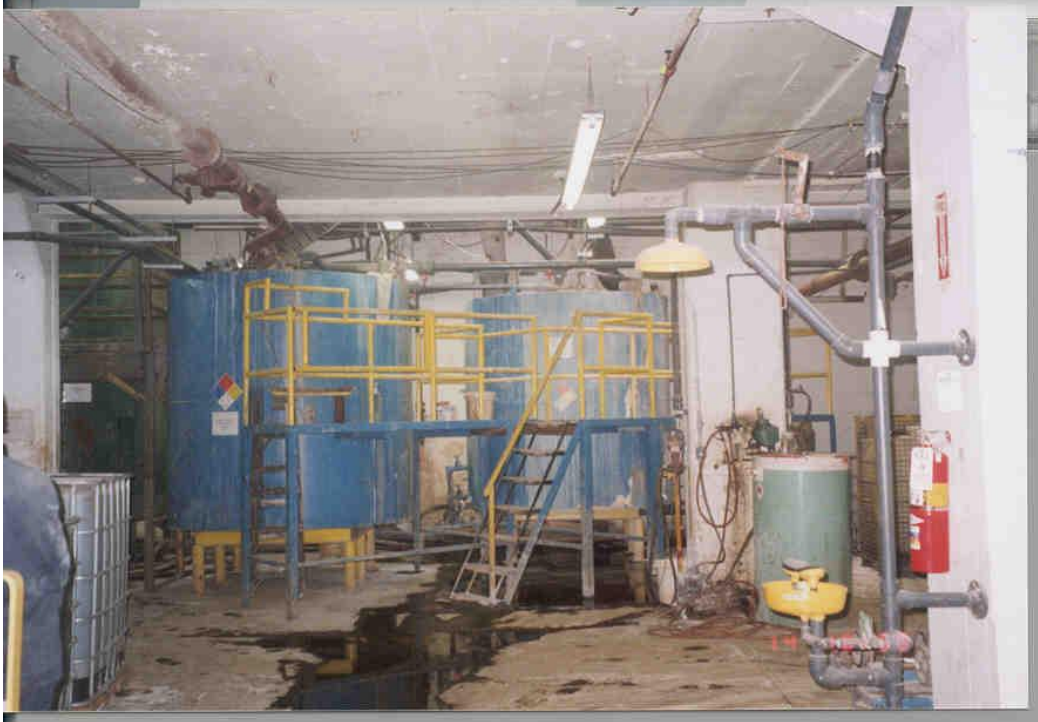
图6 工人已经习惯在该位置闻到 H 2 S 气味 来源:化学安全委员会 Chemical Safety Board [75]
