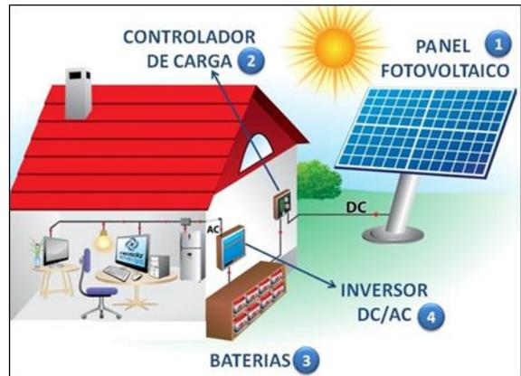
Componentes de un sistema fotovoltaico autónomo
