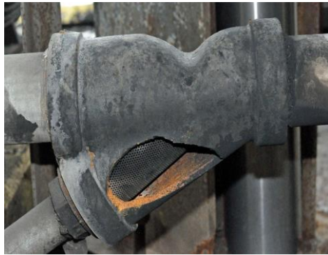
2. ábra: a szűrő falán lévő lyuk. A túlnyomás ridegtörést okozott.
