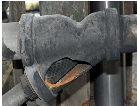
Figura 2. Un gran forat en el filtre. La pressió excessiva en va causar la ruptura fràgil.
