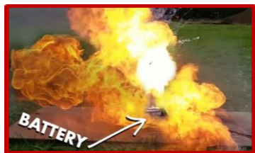
Figura 2: Demonstração de incêndio numa bateria de íons de lítio.
