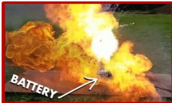
Abb. 2: Brand eines Li-Ionen-Akkus, Experimentalvorführung
