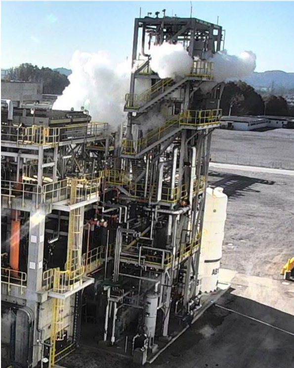
Abbildung 1: Stahlbau mit Freisetzungsstelle. Ca. 15 Sekunden nach Beginn der Freisetzung war der Stahlbau von einer HCL-Wolke eingehüllt. (Quelle: CSB Report 2021-01-I-TN)
