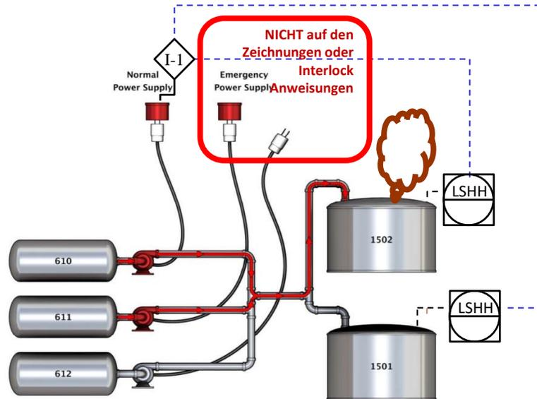
Fig. 1 Schema des Oleum Transfer Systems
