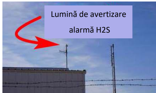
Fig. 2: Lumină de avertizare alarmă H 2 S
