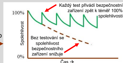
Obr. 4: Spolehlivost bezpečnostního zařízení (alarm H 2 S)
