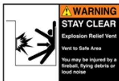
Bild 3: Varningsskylt för sprängbleck
