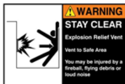
Рис. 3: Предупреждение на месте нахождения взрывозащитной панели
