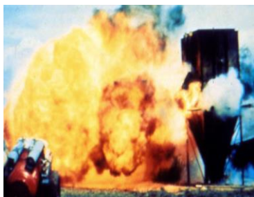
Рис. 2: Выброшенная пыль продолжает гореть за пределами емкости
