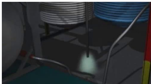
Imagine 2. Vaporii din proces eliberați la nivelul inferior în vecinătatea zonei de proces
