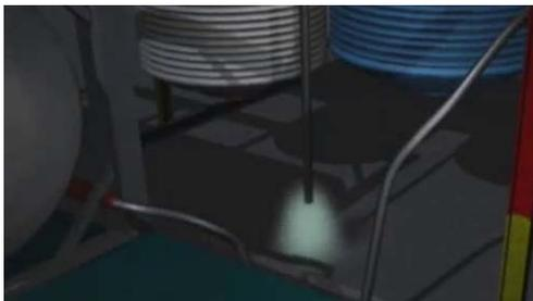
**Figura 2. Vapores de processo liberados em um nível baixo perto da área de processo**
