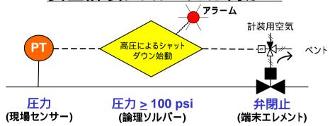
安全計装システム(SIS: Safety Instrument System)は、異常な状態が示されると、プラントを安全な状態に保つように、或いは、プラントを安全な状態に戻すように自動的に作動する。SISは、様々なプロセス危険からプラントを保護する単一または複合的な機能を備えている。この種のシステムには、安全停止システム、緊急停止システム、安全インターロック、防護計装システム、安全クリティカルシステムなど、他の多くの呼び名がある。多くの場合、SISの個々の機能は上図に示されたような3つの要素からなる:
