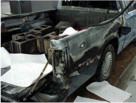
Ein Kunde befüllte einen nicht geerdeten Benzinkanister auf der Ladefläche eines Lasters. Hierbei entzündeten sich die Benzindämpfe an einer elektrostatischen Entladung. Der Brand verursachte Schäden am Fahrzeug und der Tankstelle. Der Kunde erlitt schwere Verbrennungen an beiden Beinen. Es hätte noch schlimmer ausgehen können wenn Passanten die Flammen nicht mit ihrer Kleidung gelöscht hätten.
