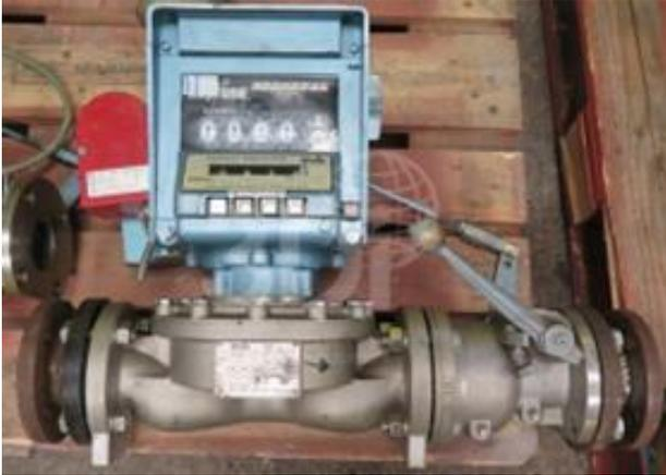
Figura 1. Contaltri pronto per la calibrazione
