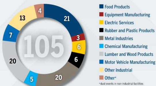
Bild 1: CSB Diagramm - Staubexplosionen (Quelle: https://www.csb.gov/assets/1/6/csb_dust_incidents.pdf )
