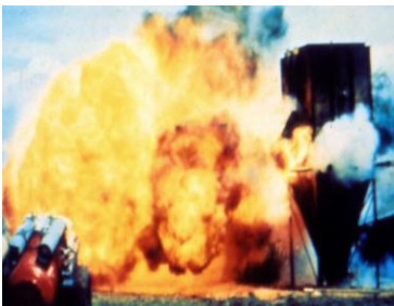
Bild 2: Druckentlastung eines Behälters nach Staubexplosion
