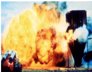
Figure 2: La poussière évacuée continue de brûler à l'extérieur de l'équipement
