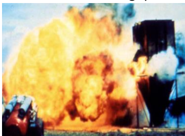
Figur 2: Udluftet støv fortsætter med at brænde udenfor beholderen
