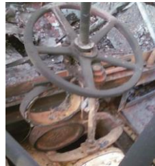
Hình 3 Van có gắn bích mù sau sự cố
