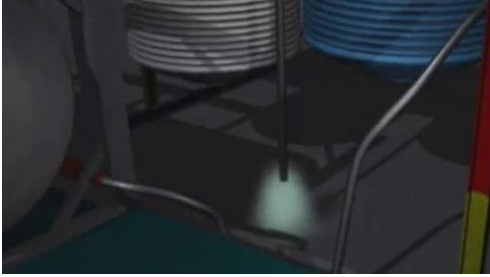
Şekil 2. Proses alanının yakınında düşük seviyede salınan proses buharları
