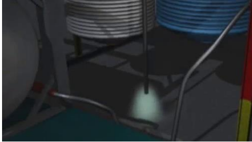
चित्र संख्या 2. प्रोसेस क्षेत्र से बाहर निम्न स्तर पर वाष्पों को बाहर छोड़ा गया
