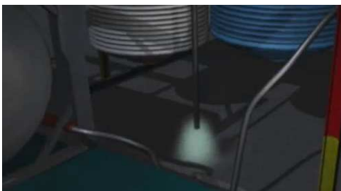
צילום 2: פליטת אדי תהליך, במפלס נמוך, ליד אזור התהליך.
