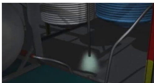
Εικόνα 2. Ατμοί διεργασίας απελευθερώνονται σε χαμηλό σημείο κοντά σε περιοχή διεργασίας
