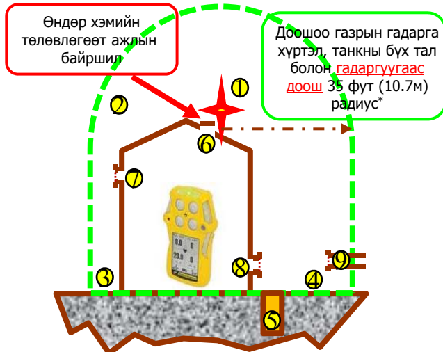
Өндөр хэмийн ажлын өмнө болон явцад “шатамхай хийн зөвшөөрөгдөх доод хэмжээ”-г шалгах цэгүүд
