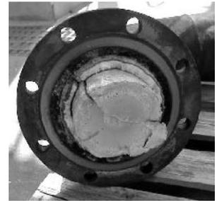
Fig. 1 Linha de vent obstruída
