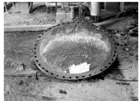
Fig. 2 Die afgeskiete deksel
