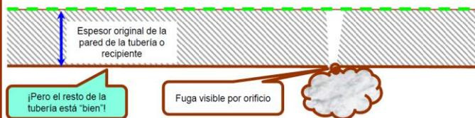
También es posible que la pequeña fuga se deba al primer punto de disminución completa, por corrosión o erosión, del espesor de la tubería o pared. Podría verse así:
