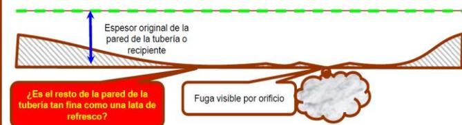
Si la disminución de espesor se produce en una superficie grande, puede romperse de manera catastrófica, liberando una gran cantidad del contenido de la tubería o del recipiente. Su intervención en la respuesta a la fuga pudiera hacer más probable dicho suceso. Los cambios significativos en las condiciones de proceso en el interior (presión, temperatura, caudal) también pueden aumentar la probabilidad del suceso.
