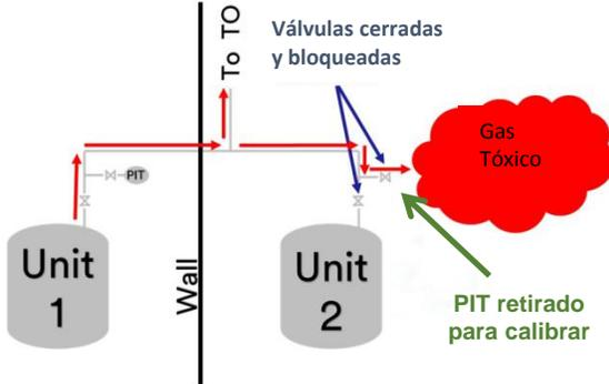
Un día o dos después de que se bloqueara la unidad 2, la unidad 1 comenzó a descargar gas tóxico a través de la línea compartida de oxidante térmico. El producto venteado de la unidad 1 fue conducido a través de la línea de venteo hacia la unidad 2. Sin embargo, el material se descargó por la válvula donde se había retirado el transmisor de presión.
