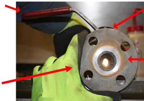
Poignée de vanne défectueuse permettant une rotation sans fermer la vanne
