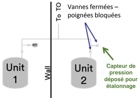
Les unités 1 et 2 partagent une ligne commune vers l'oxydeur thermique (TO). Un étalonnage d'instruments était prévu sur l'unité 2. La vanne manuelle a été fermée et consignée et le capteur de pression (PIT) déposé pour étalonnage
