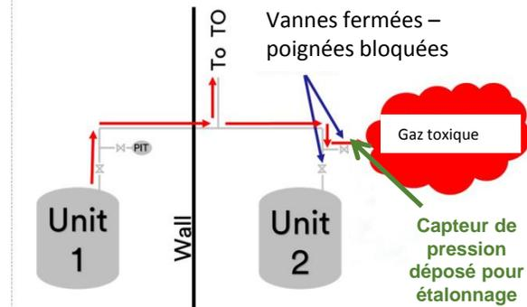
Le lendemain, l'unité 1 a émis du gaz toxique dans la ligne d'évent vers l'oxydeur thermique. Malheureusement, le gaz est sorti via la vanne manuelle sur le piquage du capteur de pression récemment déposé
