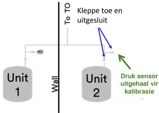
Eenhede 1 en 2 deel 'n gemeenskaplike pyplyn na die termiese oksideerder (TO). Kalibrasie was geskeduleer vir verskeie instrumente op eenheid 2. 'n Hand balklep was toe en gesluit sodat 'n druk sensor (PIT) uitgehaal kan word vir kalibrasie.
