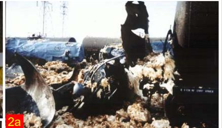
**Vorfall 2:** An einem Bahnkesselwagen mit roher Methacrylsäure (MAS) wurden Hitzeentwicklung im Tank und Stoffaustritt durch sein Überdruckventil bemerkt. Das Gelände wurde evakuiert, und nach einiger Zeit zerfetzte es den Bahnkesselwagen mit großen Schäden in der Umgebung (Abb. 2a/2b). Wegen der Evakuierung kamen keine Personen zu Schaden.
