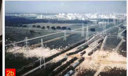
**Insident 2:** 'n Spoorweg tenker met meta-akrielsuur (MAA) het warm geword en gas by die veiligheids-klep uitgeblaas. Die area is veiligheidshalwe ge-evakueer. Na 'n ruk het die tenker ontplof met ernstige skade in die omgewing. (Fig 2a en 2b) Daar was geen beserings nie omdat almal uit die area verwyder is voor die ontploffing.
