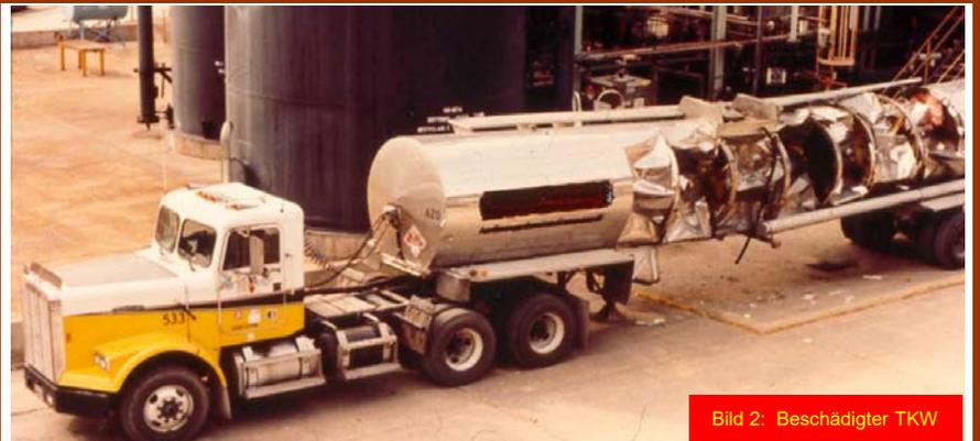
Bild 2: Beschädigter TKW
