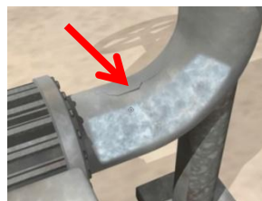
Isto é uma fissura na tubagem?
