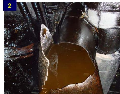
In entrambi gli incidenti il "Mechanical Integrity Management System" fallì nel rilevare o sostituire le componenti di piping deteriorate prima della loro rottura. Nell'incidente del 2013, il Sistema di Gestione della Manutenzione non assicurò che il corretto materiale di costruzione fosse utilizzato per la sostituzione del vecchio tubo. Programmi più efficaci di integrità e di manutenzione avrebbero potuto impedire entrambi gli incidenti.
