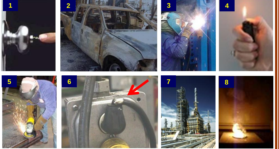
Tutuşma kaynaklarından bazı örnekler: (1) statik elektrik, (2) araç, (3) kaynak, (4) açık alev, (5) bileme, (6) hasarlı elektrik kablosu, (7) fırın, (8) piroforik (kendiliğinden tutuşan) veya ayrıışan malzeme
