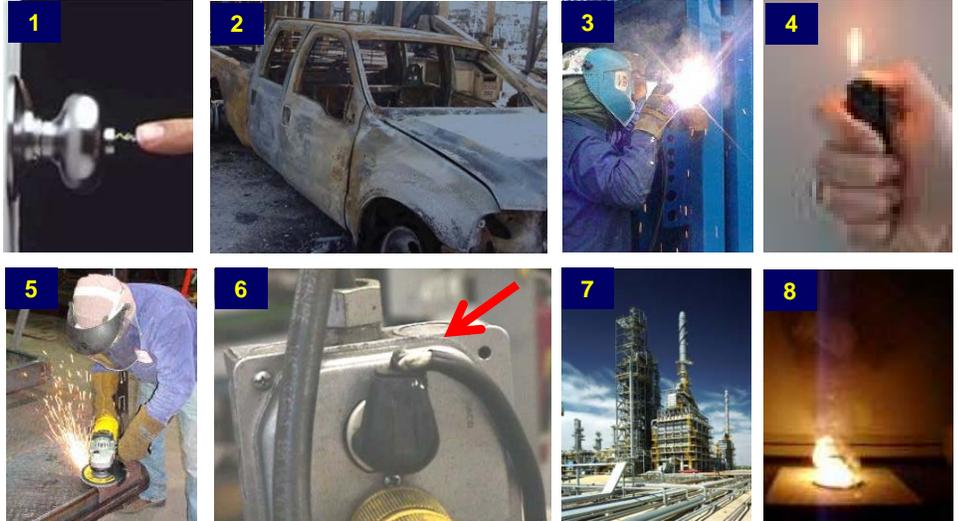
Ejemplos de fuentes de ignición: (1) electricidad estática, (2) vehículo, (3) soldadura, (4) llama abierta, (5) amolado, (6) falla en conexión de cables, (7) horno, (8) sustancia pirofórica
