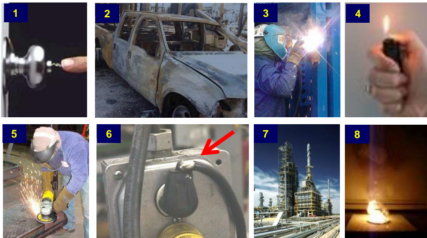
着火源の例：(1) 静電気 (2) 車両 (3) 溶接 (4) 裸火 (5) グラインダー (6) 欠陥のある電気配線 (7) 加熱炉 (8) 自然発火性 又は分解性物質
