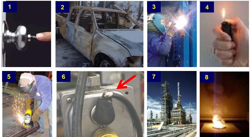
Beispiele für Zündquellen: (1) Elektrostatik, (2) Fahrzeug, (3) Schweißen, (4) offene Flamme, (5) Schleifen, (6) defekte Stromleitung, (7) Verbrennung, (8) Selbstzündung oder -zersetzung
