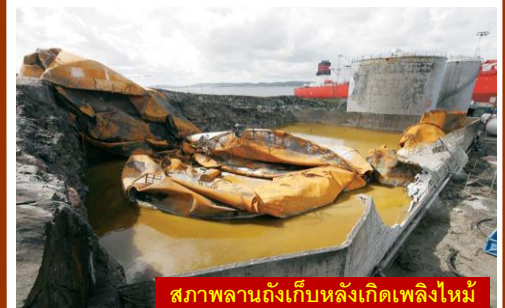
สภาพของอุปกรณ์ดูดซับด้วยชั้นของคาร์บอนหลังเกิดเพลิงไหม้
