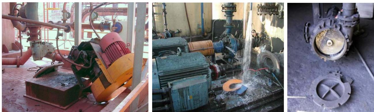
A resposta deve ser "sim" ou nós não teríamos um assunto para este *Beacon*! As bombas centrífugas das figuras acima são todas elas bombas d'água que explodiram. As explosões não ocorreram por causa de qualquer contaminação ou reação química com algo que não deveria estar na bomba. Na verdade, explosões como estas têm acontecido com águas muito puras – bombas d'água de alimentação de caldeiras, bombas de condensado e bombas de água deionizada.
