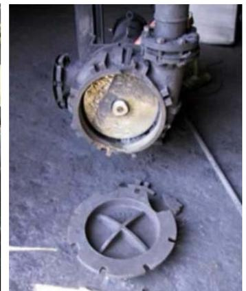
La réponse doit être "oui" ou nous n'aurions pas de sujet pour ce *Beacon* ! Les pompes centrifuges dans ces photos sont toutes des pompes d'eau qui ont explosé. Les explosions ne sont pas survenues à cause d'une contamination ou d'une réaction chimique avec quelque chose qui n'était pas supposé être dans la pompe. En fait, des explosions comme celles-ci sont survenues avec de l'eau très pure – pompes d'eau d'alimentation de chaudière, pompes de condensat et pompes d'eau déionisée.
