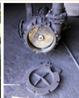
答案當然是“會”，否則本期「明鑑 (Beacon)」就沒有個主題！附圖中的離心泵浦全都是發生爆炸的水泵。爆炸並非因為任何污染，或者與某種不應該在泵浦內的東西起化學反應。事實上，像這樣的爆炸已發生在非常純淨的水-鍋爐給水泵浦、凝結水泵浦與去離子水泵浦。
