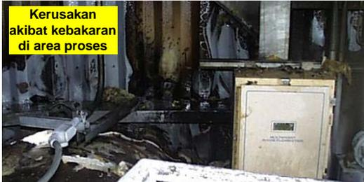
Beberapa peralatan proses, pipa, struktur baja, dan lantai ditutupi oleh polimer kering dari tumpahan sebelumnya. Api kemudian menyebar dari drum sampah ke tumpahan polimer tsb. Akibatnya api semakin membesar dan mengakibatkan kerusakan yg parah pada bangunan, peralatan proses, instrumentasi, dan peralatan kontrol. Meskipun tdk ada yg terluka, tetapi pabrik ditutup utk jangka waktu yg panjang, dan kerusakan tsb mengakibatkan kerugian ratusan ribu dolar.
