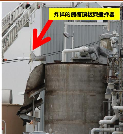
某承攬焊工和領班正在大氣壓力下之聚氟乙烯 (polyvinyl fluoride) 漿料儲槽頂上修理攪拌器支架。儲槽內含有易燃的氟乙烯氣。引發爆炸造成焊工死亡，領班受傷，炸掉大部份的槽頂，攪拌器則垂掛在槽邊。美國化學安全委員會 (US Chemical Safety Board, 簡稱CSB) 調查此意外事故，並確定是氟乙烯氣由相連通的製程儲槽滲入此儲槽內，並未被檢測到，而在焊工作業當中被點燃引爆了。
