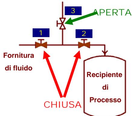
2. Valvole di doppio blocco e scarico settate per l'isolamento del fluido
