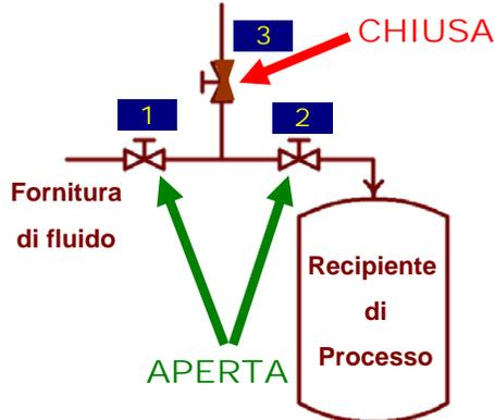
1. Valvole di doppio blocco e scarico settate per l'alimentazione del fluido
