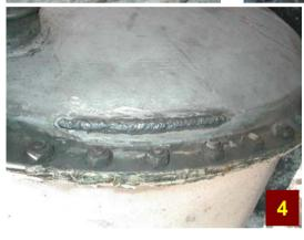
一个压缩空气罐出现了故障,它将(图1)中的罐体底部冲脱,其碎片飞射出来,撞击到一堵混凝土墙体上,打穿了墙(图2)。事故后的调查揭示出罐体本身存在严重问题,它包括出现故障的罐体底部有严重的腐蚀和锈蚀(图3),以及在过去某个时间做过的不恰当的焊缝维修(图4)。虽然焊缝维修不是这次事故的原因,但它却表明罐体没有得到正确维护和检查,这本身就可能导致罐体的故障。幸运的是,事故发生时,没有人在现场附近,没有人因此而受
