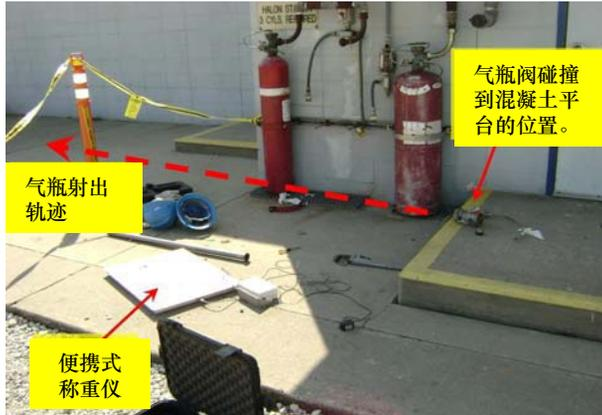
气瓶阀碰撞到混凝土平台的位置。
