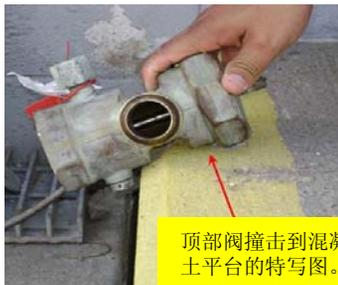
顶部阀撞击到混凝土平台的特写图。
